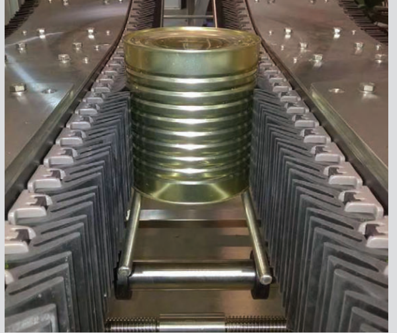
Shrink Ambalajlaması için tel bant yerine kullanılan yüksek sıcaklığa haiz plastik bant
